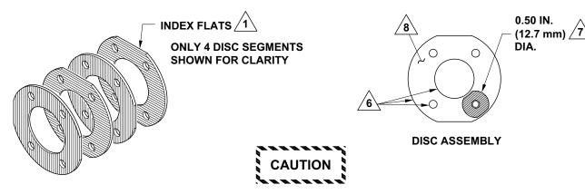
MAKE SURE THAT THE ORDER IN WHICH THE DISC SEGMENTS ARE STACKED DOES NOT CHANGE AFTER THE COUPLING DISC PACK HAS OPERATED.
